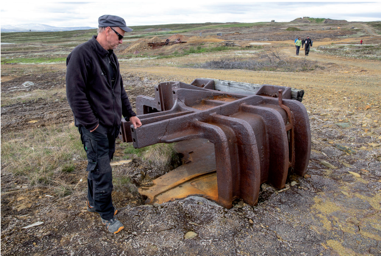
Hadfields 24 x 19 grovknuser (lomme av kjeftetygger), tatt ut av knuseriet og brukt som velteknuser i sen driftsfase, montert på tremerier for flytting, etterlatt nær skrottippen ved Nedre Storwartz som ses bak. I horisonten skimtes Øvre Storwartz.
