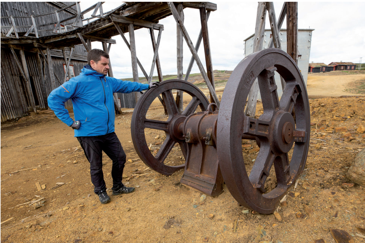
Del av kjeftetygger med svinghjul og konisk aksel, liggende utenfor flotasjonsverket.
