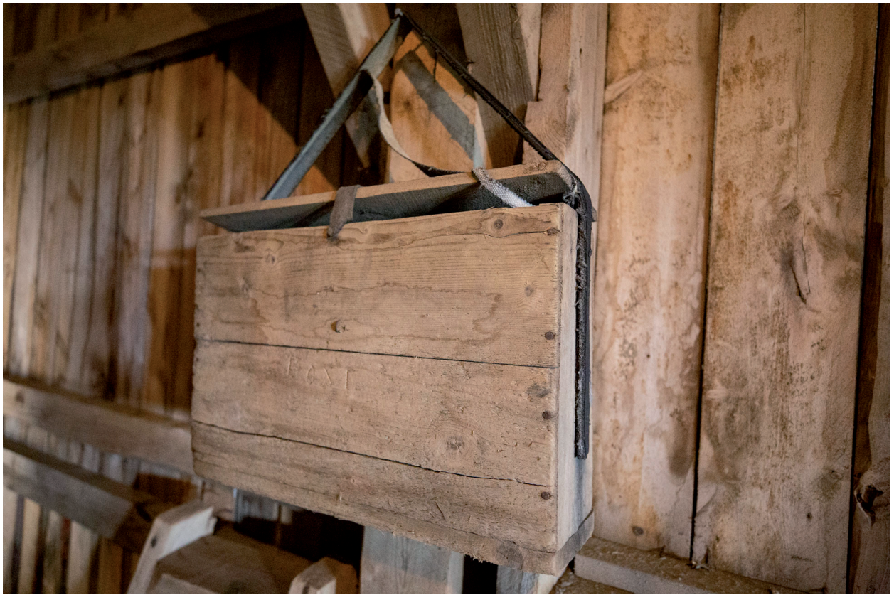
Postveske i tre med lærreim for sending med taubane mellom Olavsgruva og Nedre Storwartz, opphengt i taubane-sentralen ved Olavsgruva.
